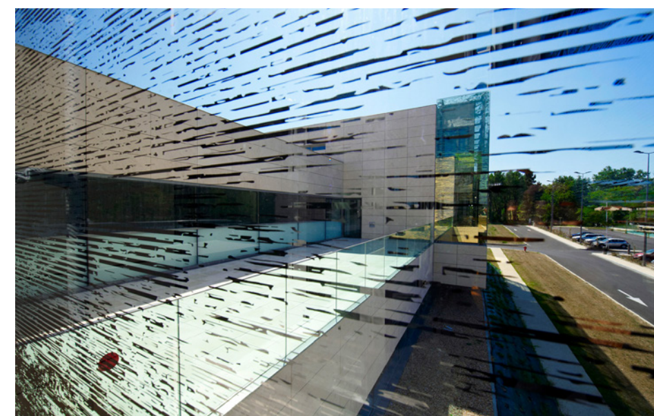
Exemple de système à mettre en place pour éviter les collisions d'oiseaux
