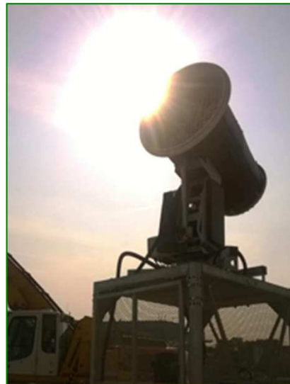
Brumisateurs sur le Port de Tolbiac Paris > Cemex Granulats
