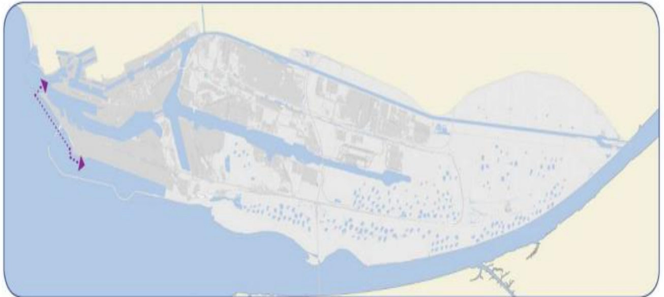
Figure 2 : Principe de l'accès fluvial direct à Port 2000 au travers de l'aménagement dit de la Chatière
